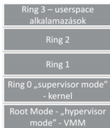
1. ábra. Hardveres virtualizáció esetén létező CPU Ring-ek (forrás: [18])
